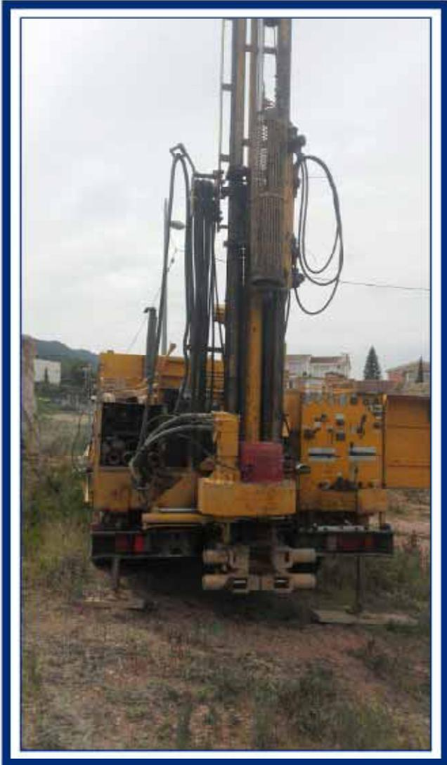
REALIZACIÓN DEL ENSAYO DE PENETRACIÓN DINAMICA PD-1
